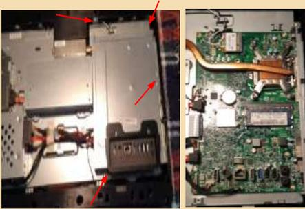
4e) Déverrouiller la RAM de l'emplacement #1 , et la retirer.
