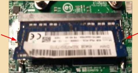
4f) Insérer fermement la nouvelle RAM dans l'emplacement inférieur et peser dessus jusqu'à ce quelle se verrouille en position horizontale.
